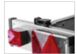
Schnellspanverschluss an der ausziehbaren Lichtleiste zur Arretierung
