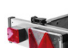
Schnellspanverschluss an der ausziehbaren Lichteiste zur Arretierung
