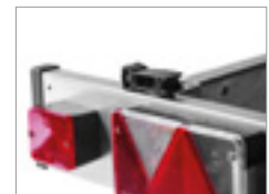
Schnellspanverschluss an der ausziehbaren Lichtleiste zur Arretierung
