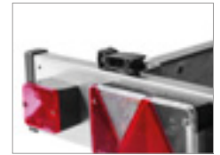
Schnellspanverschluss an der ausziehbaren Lichtleiste zur Arretierung
