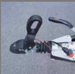
Sicherheitskupplung mit Spurstabilisierung
